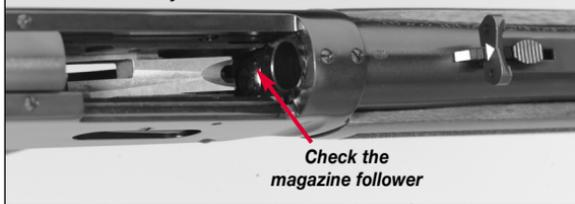
**BY LOOKING THROUGH THE TOP OF THE OPEN RECEIVER, THAT THE MAGAZINE FOLLOWER IS SHOWING—AND NOT A SHELL BASE.**
